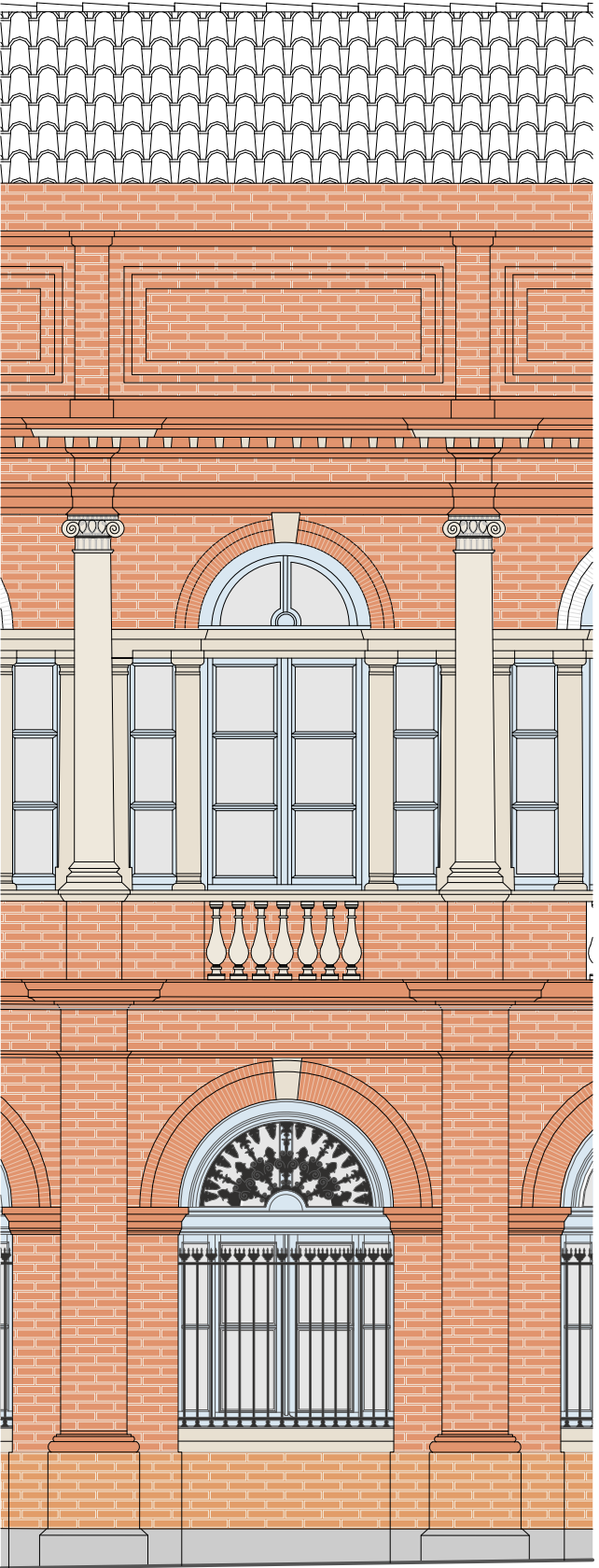
MENUISERIES BLEU CLAIR - ETAT ACTUEL EFFACEMENT DE LA MENUISERIE ET DE LA LISIBILITÉ DES MODÉNATURES
